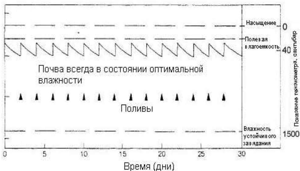
Рисунок 12-4. Составление плана поливов с помощью тензиометров
